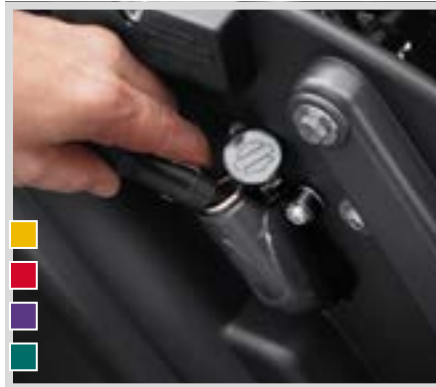
D. ZUSÄTZLICHER STROMANSCHLUSS – SATTELASCHENMONTAGE
