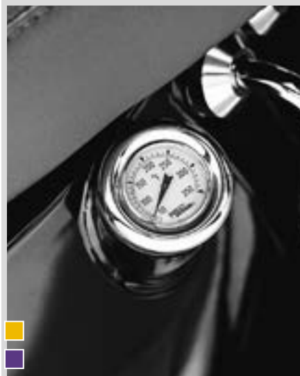
B. ÖLPEILSTAB MIT TEMPERATURANZEIGE (SOFTAIL ABGEBILDET)
